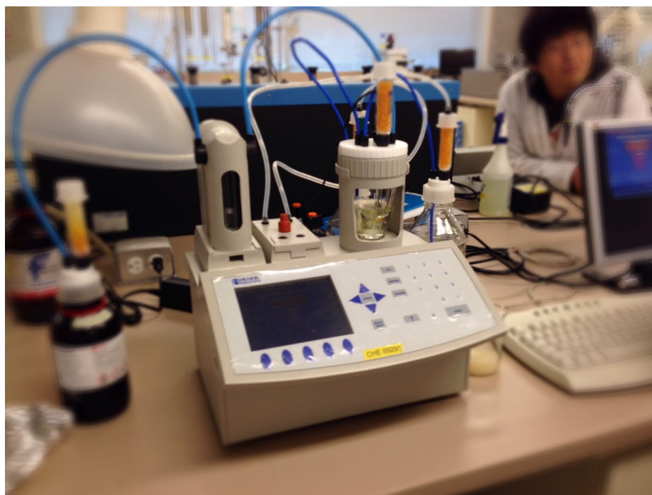
Figure A2: Karl Fischer Volumetric Titrator Apparatus
